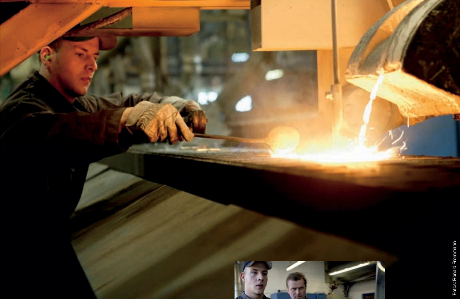
Christian nimmt eine Probe (Bild oben). Am Computer kontrolliert Sven die Temperatur der Schmelze (Bild links).
